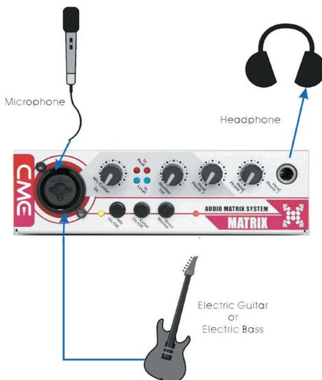
注：面板上的复合接口同时只能连接一个设备，上图仅示范复合接口既可用于连接XLR接口的话筒，又可用于连接TS接口的电吉他或电贝司，但两者不可同时连接。
